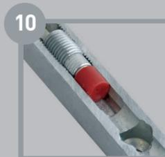
10 Внутри нижней петли створки есть втулка с фиксатором положения, из высокопрочного полимера, которая препятствует выкручиванию регулировочного винта при повороте створки. Регулировочный винт изначально зафиксирован в центральном положении, что исключает самопроизвольное изменение его положения при транспортировке изделия.
