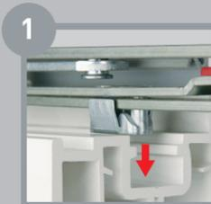
1 Фиксаторы в фурнитурном пазе для всех элементов створки позволяют закрепить элемент фурнитуры до момента ввинчивания саморезов и препятствуют их смещению от проектного положения в момент ввинчивания саморезов.
