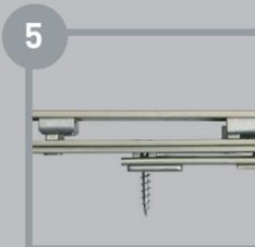
5 Надёжное соединение среднего запора с ножницами с помощью самореза.
