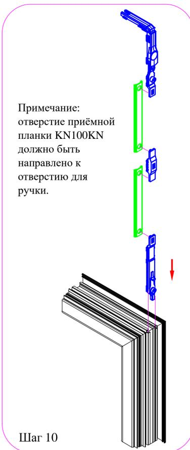
Примечание: отверстие приёмной планки KN100KN должно быть направлено к отверстию для ручки.
