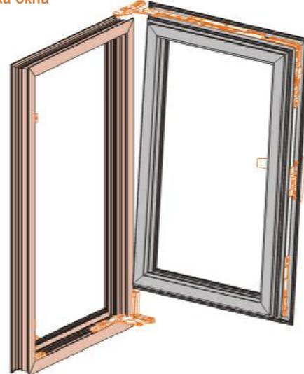
B.4 Переключите ручкой предохранитель влево или вправо и одновременно поверните ручку вовнутрь. Следите за тем, чтобы фиксатор был вровень; в таком положении верхнюю петлю можно легко вставить в паз рамы.
