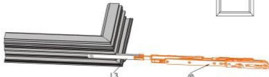
1.2 Установите ножницы в правильном положении и зафиксируйте его винтом сверху.
